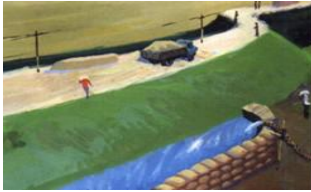
图 5-8 蓄水反压方法示意图
