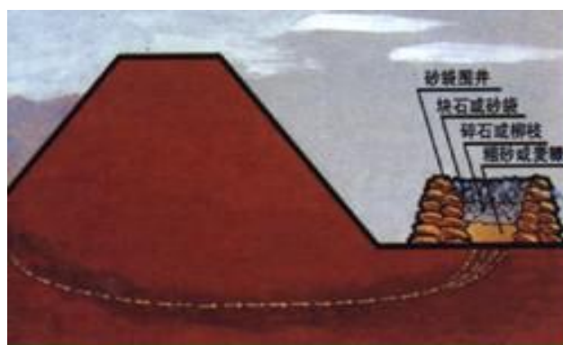
图 5-7 反滤围井方法示意图
