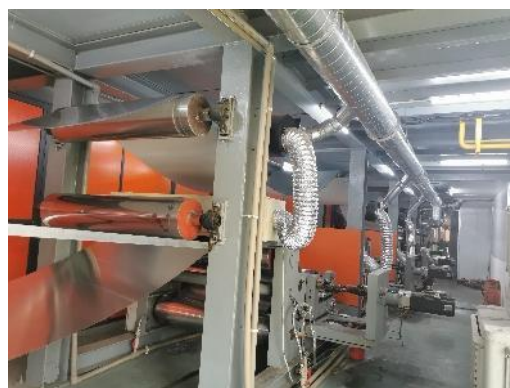
印花机台-采用侧吸式吸风口抽风收集
