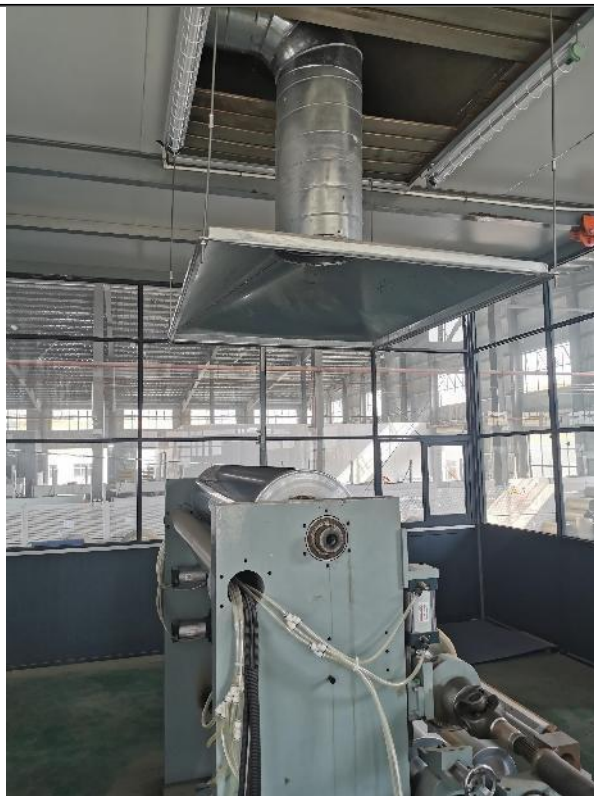
底漆辊涂房-设置为局部围蔽区域，采用上吸式集气罩进行负压抽风、车间/区域内呈负压
