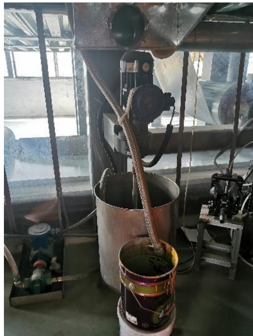
调漆间-设置为局部围蔽区域，采用顶吸式抽风口进行负压抽风、车间/区域内呈负压
