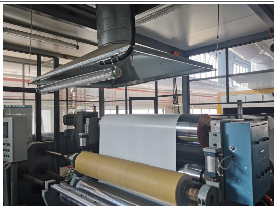
面漆辊涂房-设置为局部围蔽区域，采用上吸式集气罩进行负压抽风、车间/区域内呈负压
