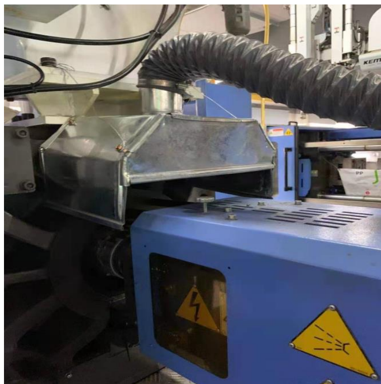
图 4-1 同类型注塑废气 U 形环状包围型集气罩示意图
