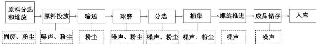
图 2-3 现有工程工艺流程及产排污环节图
