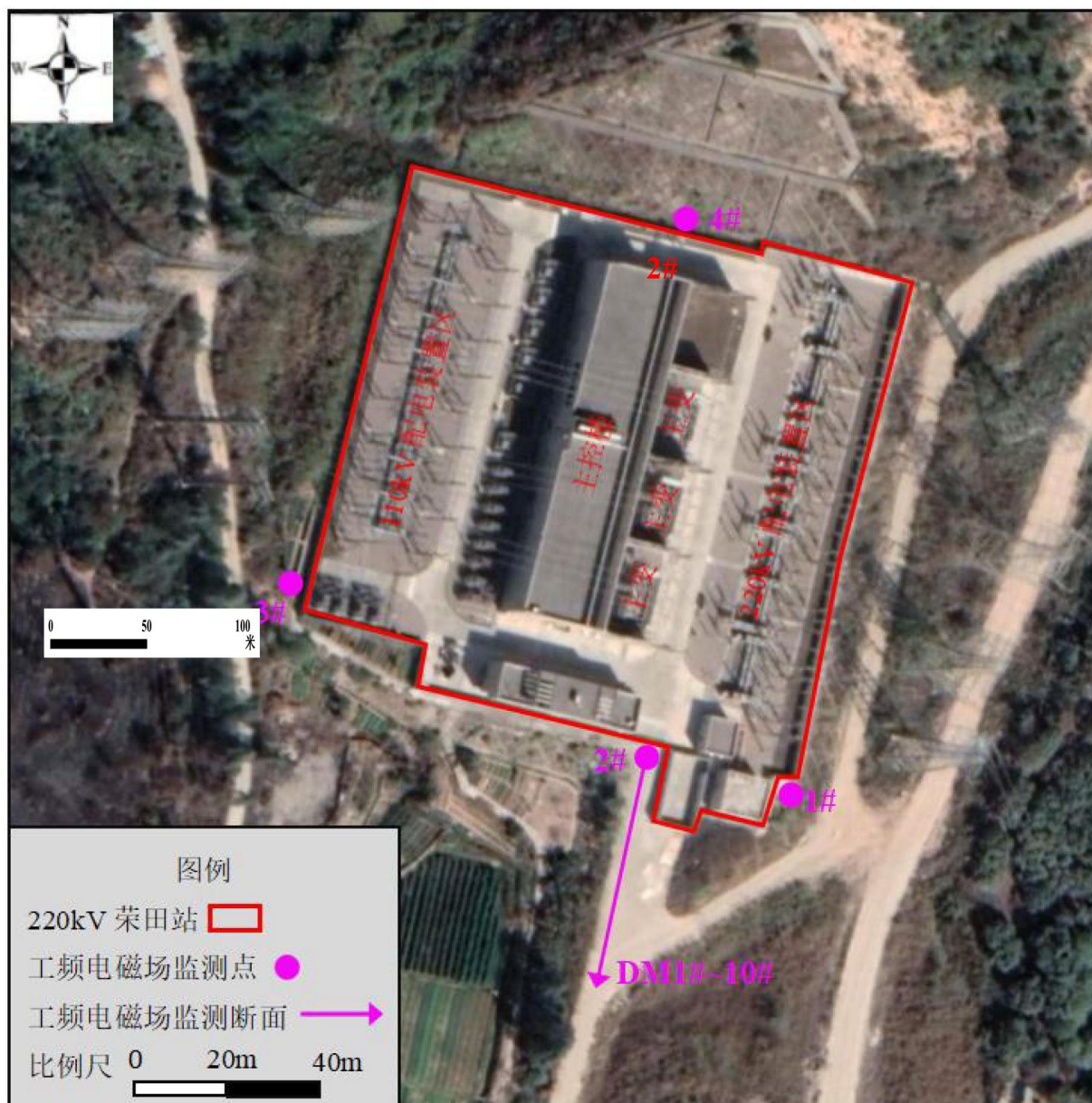
图 3-1 220KV 荣田变电站监测布点图
