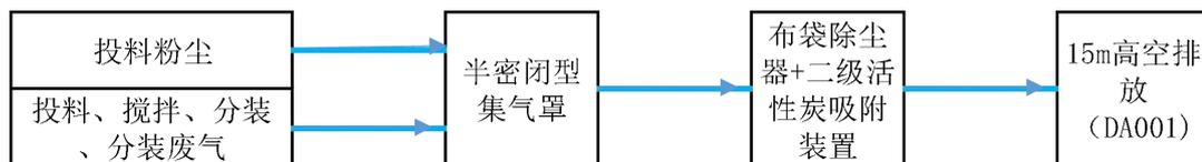
图 4-1 废气治理设施工艺流程图
