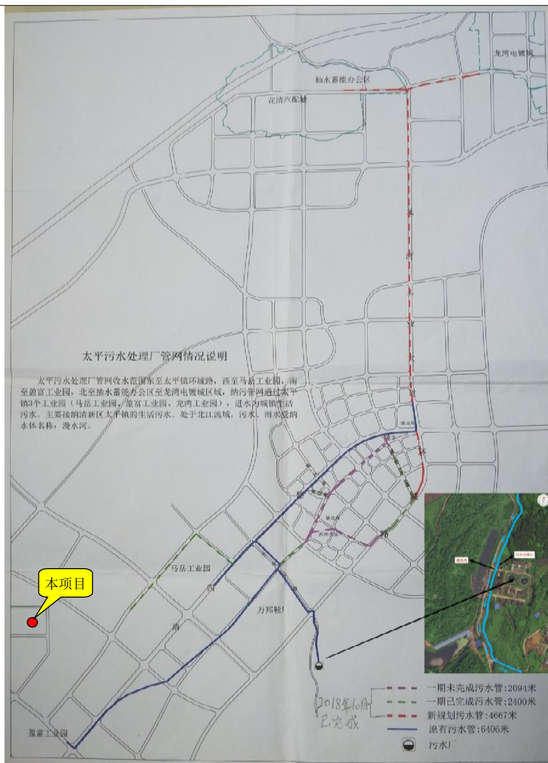
图 4-1 太平污水处理厂纳污管网图
