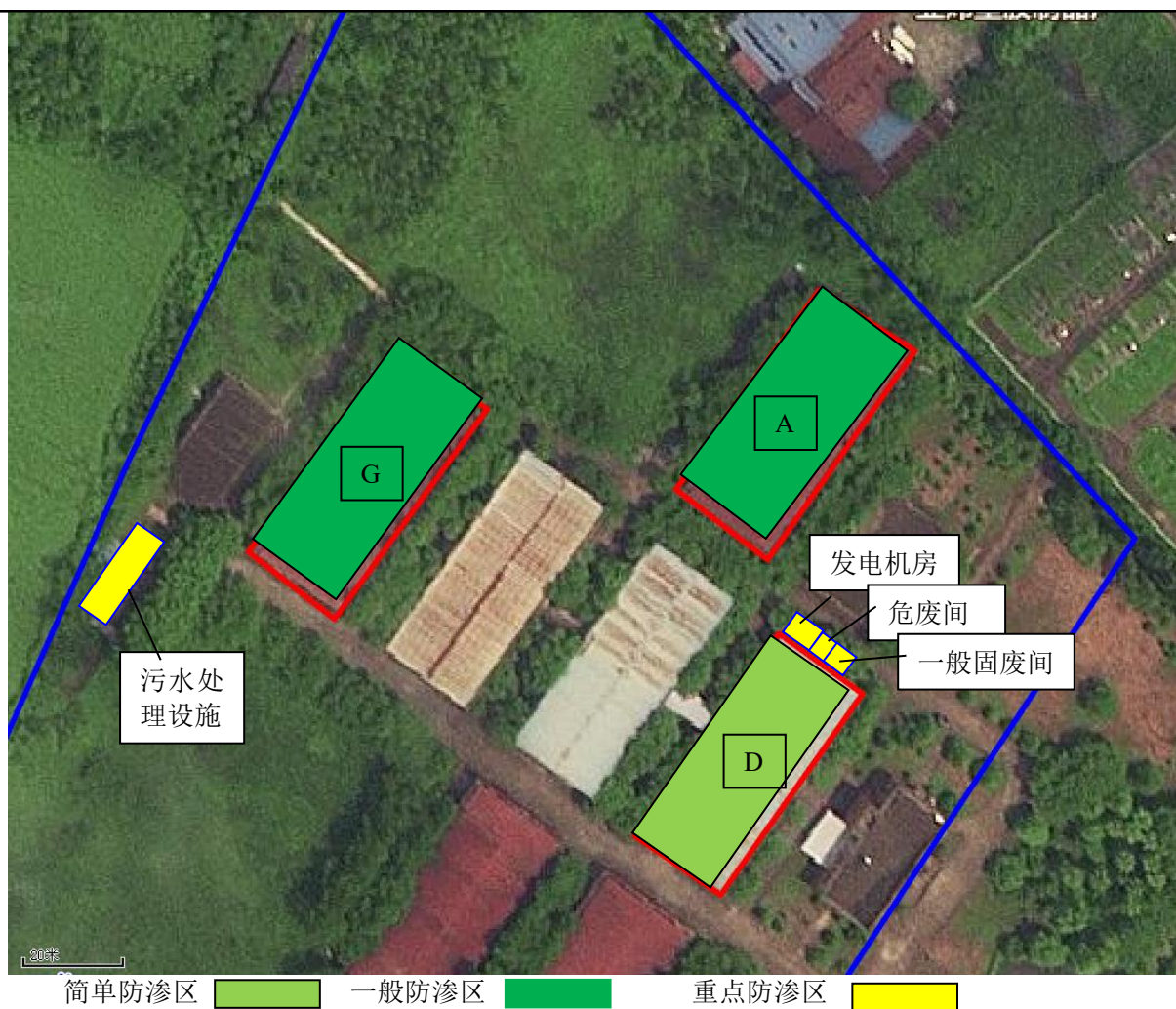
图 1. 地下水污染防治区防渗示意图
