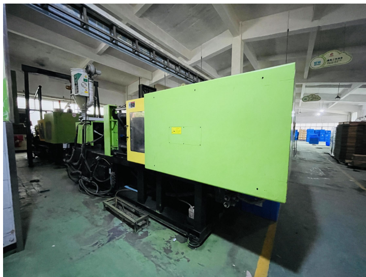
现有车间生产设备（射出机）照片图
