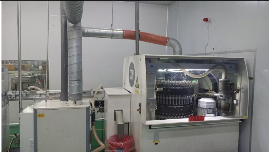
图 4-1 现有项目塑盖成型设备密闭情况图片
