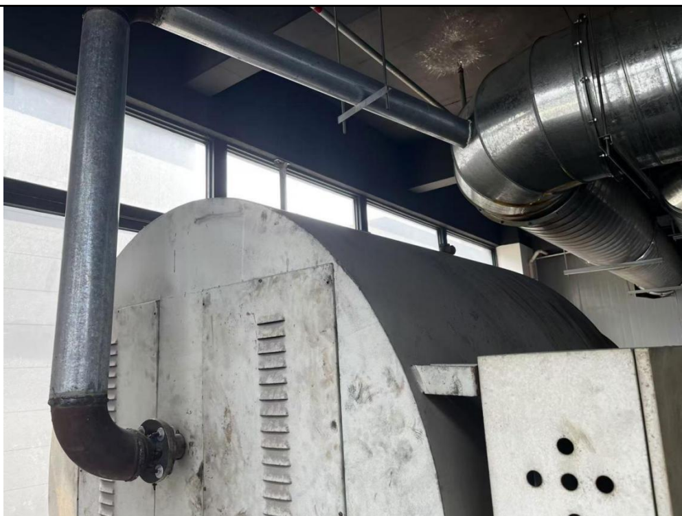
热解过程段设备直连管道收集
