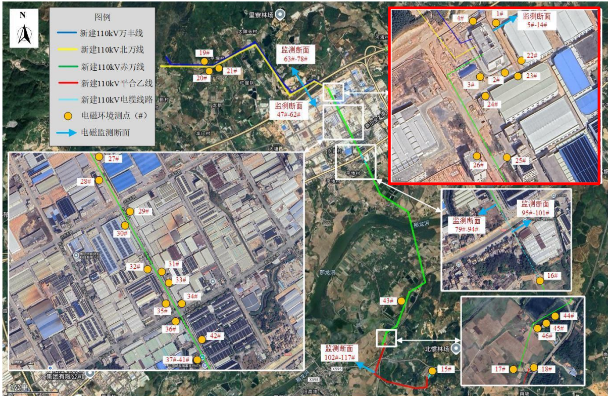
ZT-图 8.1-3 110 千伏万象变电站监测布点图
