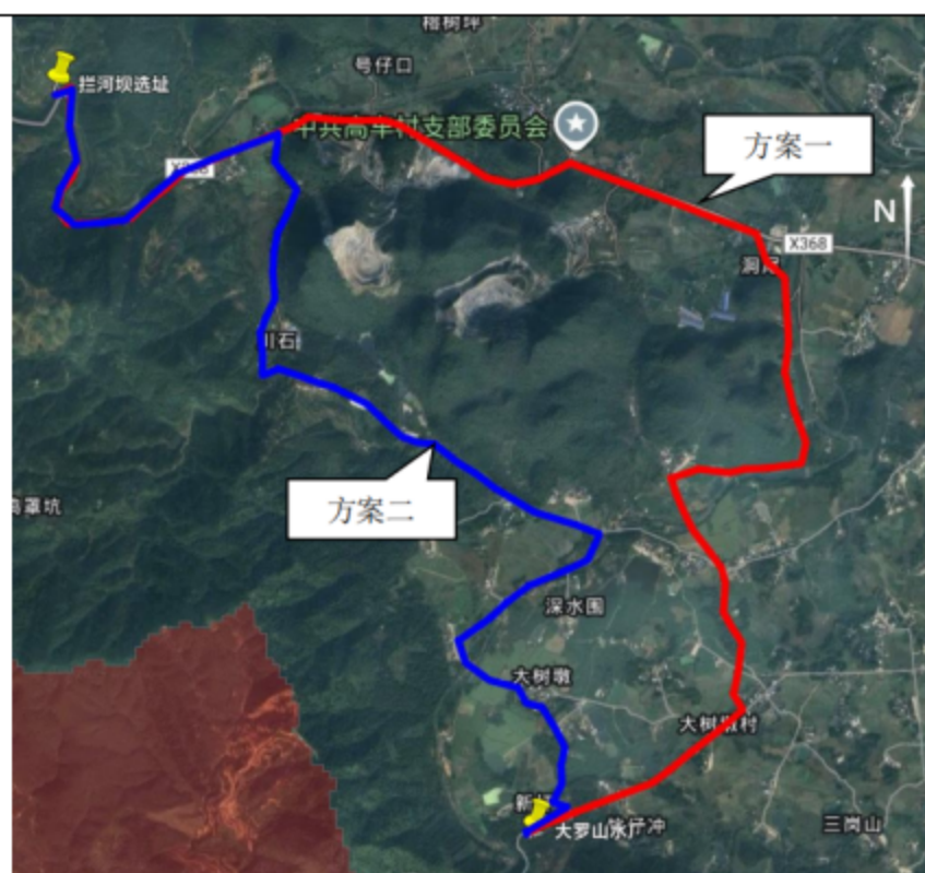
图 4-3 输水管线选址示意图（推荐方案一）
