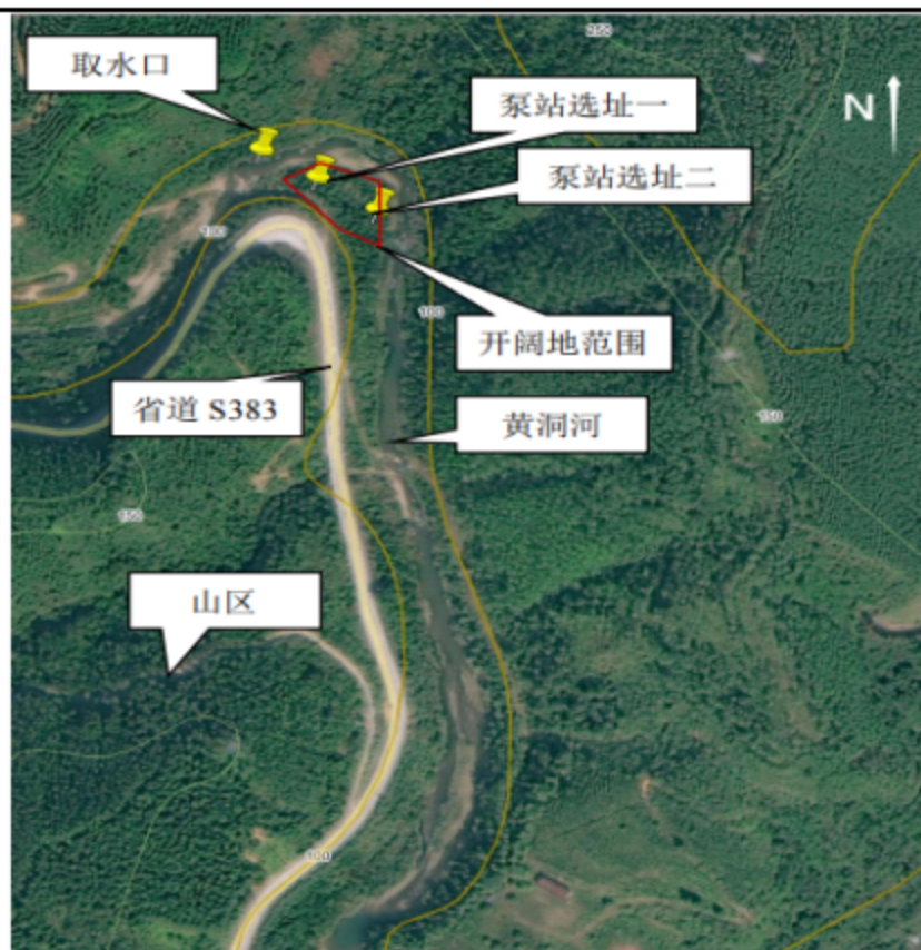
图 4-2 泵站选址示意图（推荐选址一）
