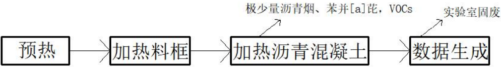
图 2-5 沥青含量测定流程及产污节点图
