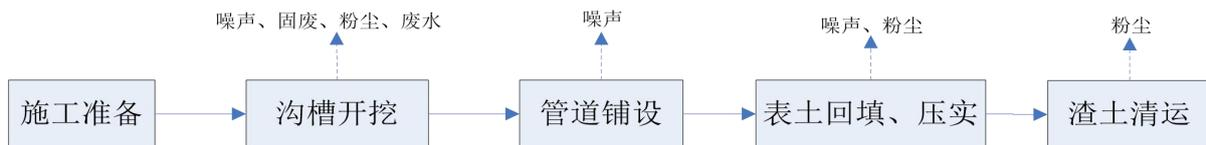
图 1 项目施工期天然气管道施工工艺及产污环节
