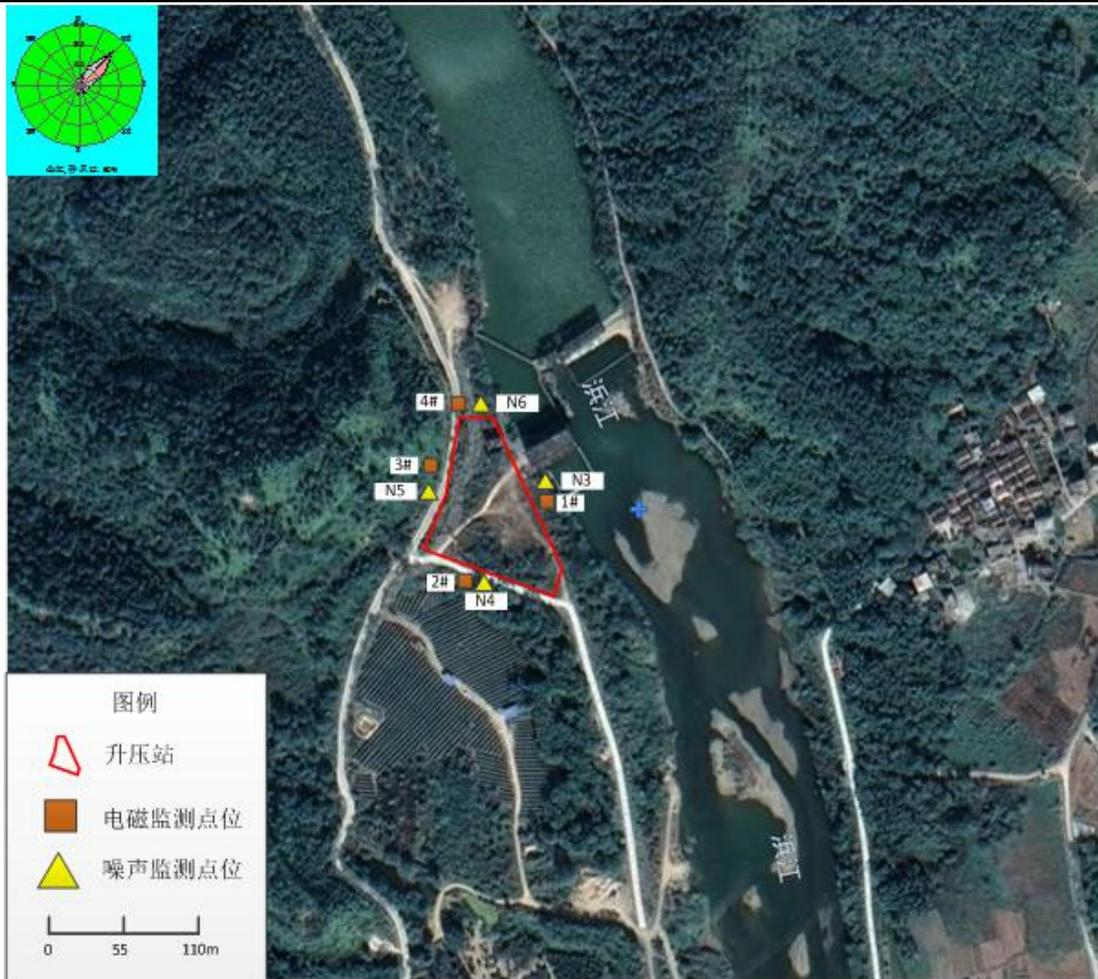
图 2-1 项目升压站电磁、噪声监测点位图
