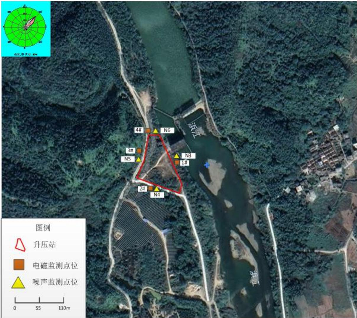
附图 6 项目升压站电磁、噪声监测点位图
