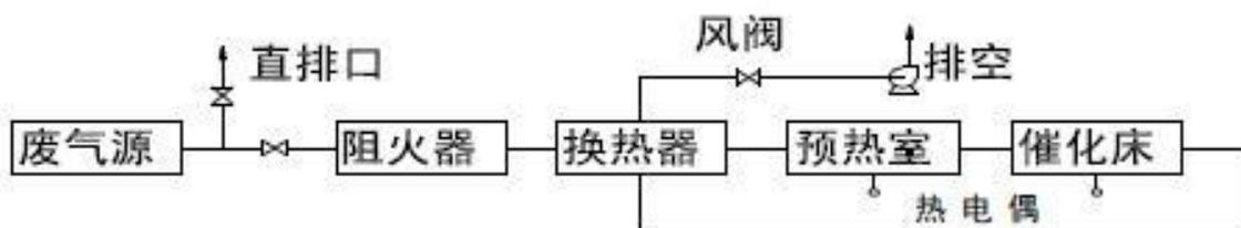
图 4-2 催化燃烧装置工艺流程示意图
