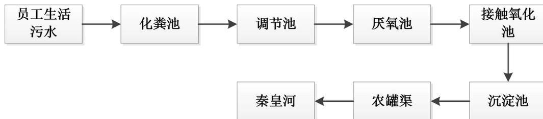
图 4 生活污水处理工艺流程图
